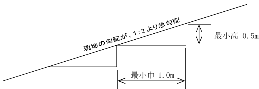
図 1-2-1 盛土基礎地盤の段切
